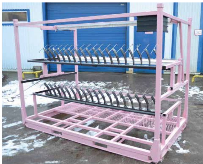
Палета для перемещения и хранения стальных элементов кузова автомобиля
