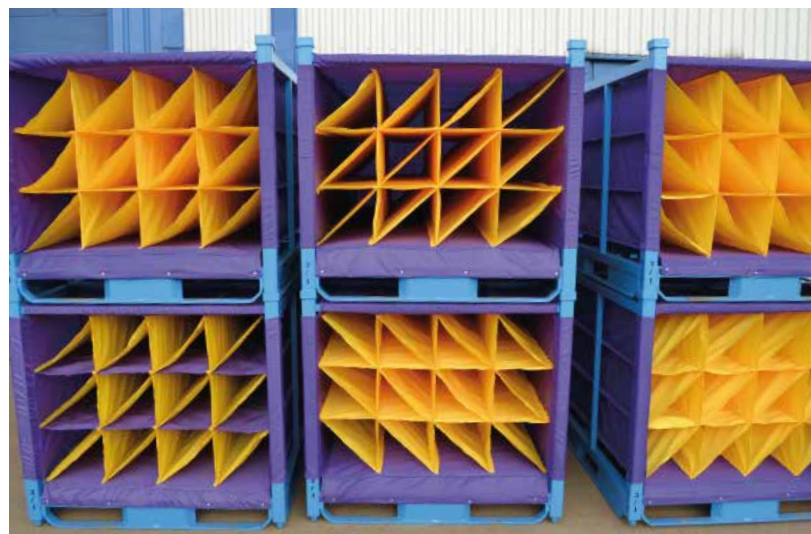
Палета для бережной перевозки и хранения пластмассовых элементов автомобиля
