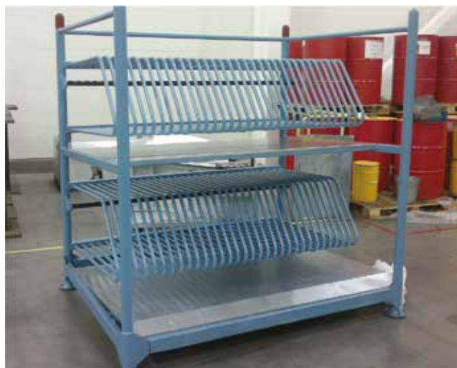
Палета для перемещения и хранения стальных элементов кузова автомобиля
