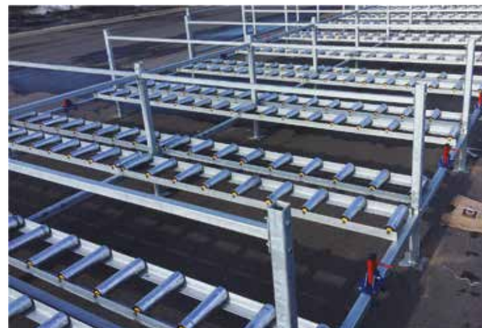
Конвейерная система для хранения авиационных контейнеров
