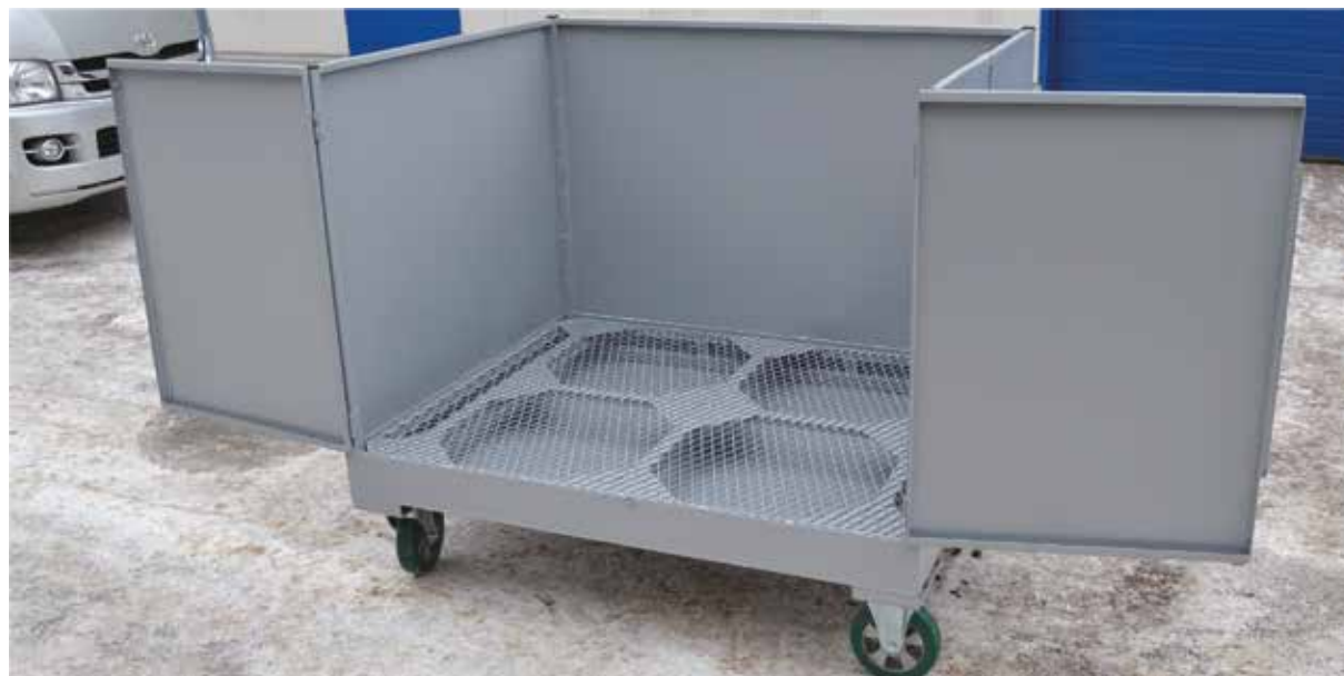
Тележка для наливных грузов с поддоном для накопления проливов
