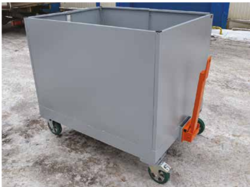
Тележка для наливных грузов с поддоном для накопления проливов
