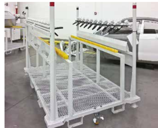
Тележка для перевозки капотов автомобилей
