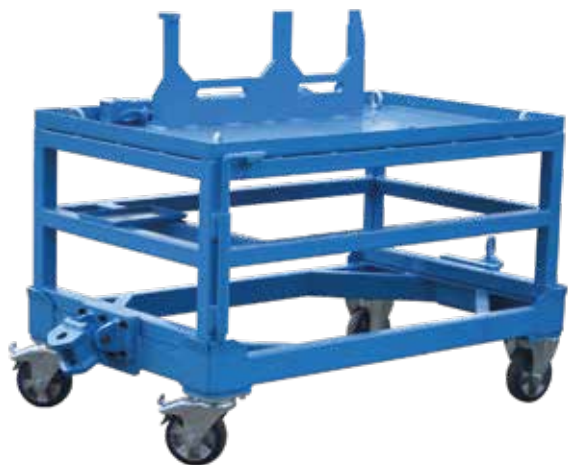
Тележка для сборки автомобильных двигателей
