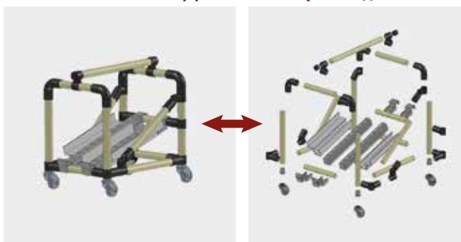
Модульная конструкция (на примере гравитационного стеллажа)
